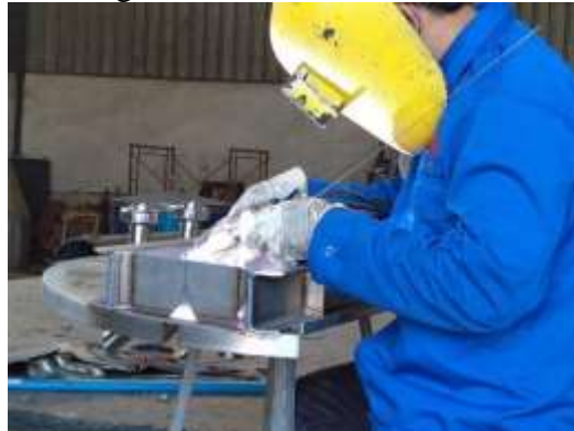
Gambar 13 Pengelasan nozzle pada fix top cover Outlet dipasang pada bagian bottom shell seperti gambar dibawah ini;
