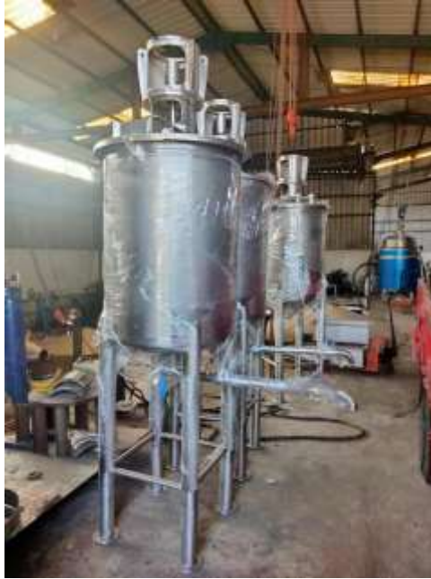
Gambar 16 Hasil Akhir Proses Produksi Tangki Mixer Kapasitas 500 Liter
