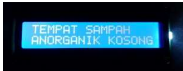
Gambar 6 Tampilan Data LCD Anorganik Pada Kondisi TSO Anorganik Kosong
