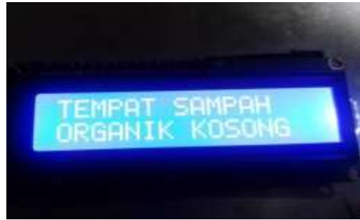
Gambar 4 Tampilan Data LCD Organik Pada Kondisi TSO Organik Kosong
