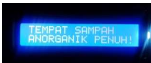
Gambar 7 Tampilan Data LCD Anorganik Pada Kondisi TSO Anorganik Penuh
