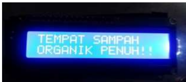
Gambar 5 Tampilan Data LCD Organik Pada Kondisi TSO Organik Penuh
