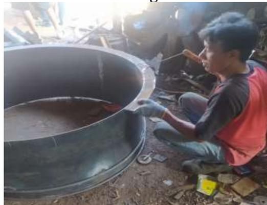
**Gambar 5. Proses Pemasangan Plat Pada Cover Blower**
