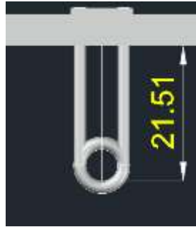
Gambar 7. Tempat pengait di bagian atas daisa
