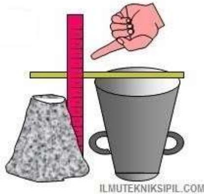
**Gambar 5.** cara mengukur slump beton
