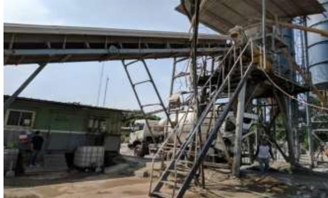
**Gambar 2.** material dari *coltbin* menuju mesin wet mix untuk diaduk
