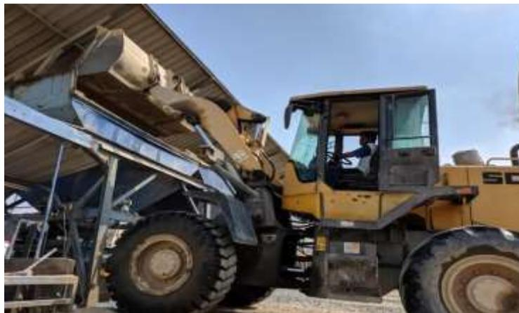
**Gambar 1** pengisian material menggunakan truck loader kedalam *coltbin*
