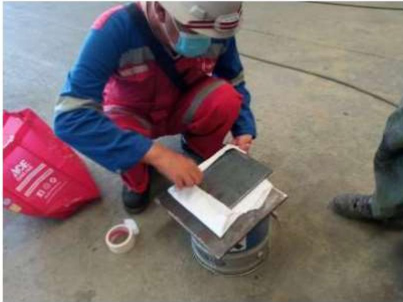
Gambar 3 Kegiatan Inspeksi Material Setelah Di-Sandblasting
