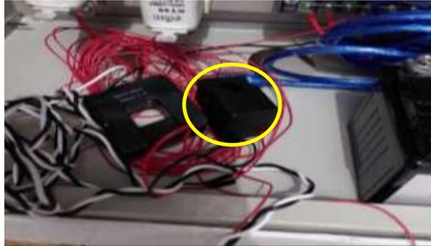
**Gambar 7.** Sensor Tegangan PZEM-004T
