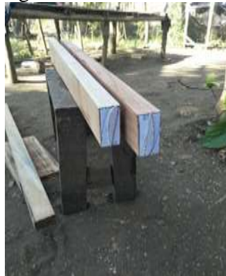
Gambar 5. Penempelan mal airfoil 0 pada ujung bilah
