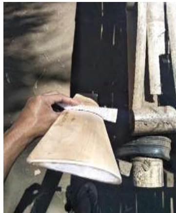
Gambar 7. Proses pencocokan mal Airfoil dengan bilah
