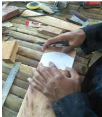
Gambar 8. Pembuatan mal pangkat
