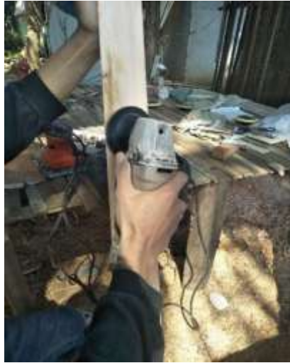
Gambar 6. Proses penggerindaan mengikuti bentuk mal
