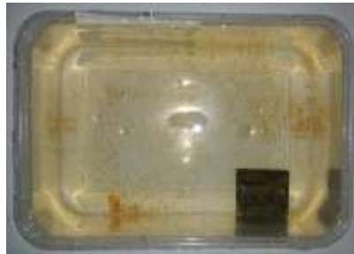
Gambar 4 Proses perendaman dengan larutan NaCl 3,5% selama 168 jam
