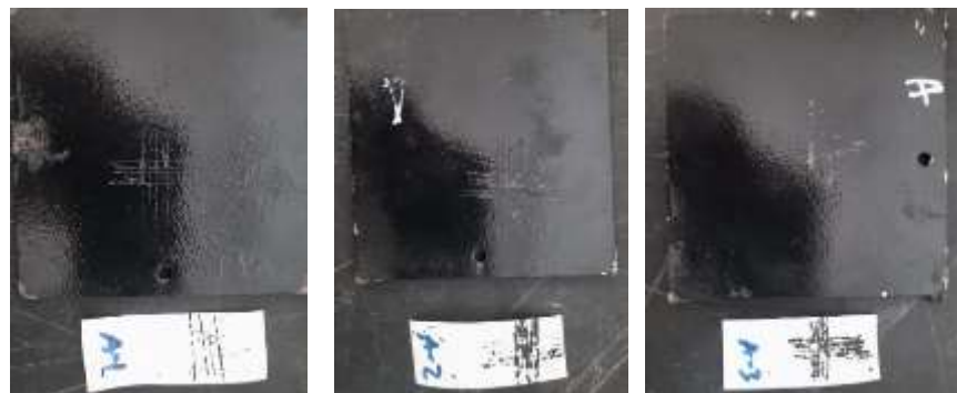
Gambar 14 Hasil pengujian daya rekat ASTM D3359 pada spesimen A.
