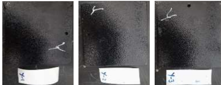
Gambar 23 Hasil pengujian daya rekat ASTM D3359 pada spesimen Y Berdasarkan pengujian daya rekat dengan standar ASTM D3359 pada spesimen Y pada suhu pengeringan 180°C didapatkan hasil sebagai berikut:
