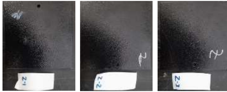
Gambar 25 Hasil pengujian daya rekat ASTM D3359 pada spesimen Z
