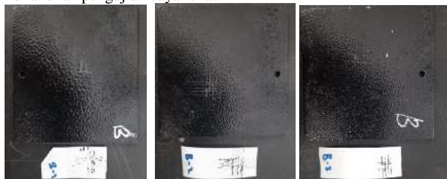
Gambar 17 Hasil pengujian daya rekat ASTM D3359 pada spesimen B Berdasarkan pengujian daya rekat dengan standar ASTM D3359 pada spesimen B dengan suhu pengeringan 180°C didapatkan hasil sebagai berikut:
