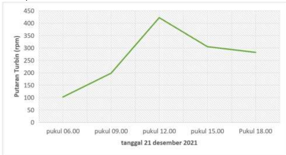
Gambar 5 Gfarik Hasil Pengujian Putaran Turbin
