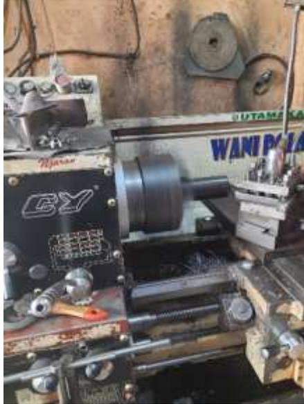
**Gambar 4.** Proses pembuatan kampuh las setelah pemakanan
