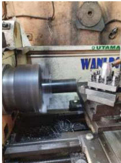
Gambar 3. Proses pembuatan kampuh las sebelum pemakanan
