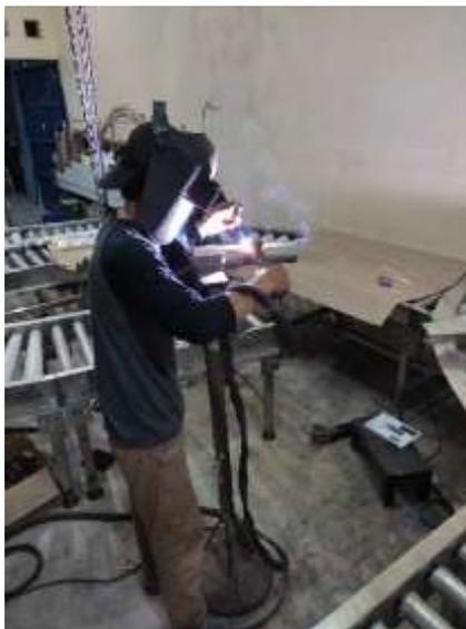
**Gambar 5.** Proses pengelasan GTAW
