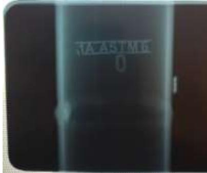
**Gambar 9. Hasil radiographic spesimen 3**
