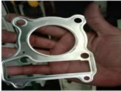
Gambar 2. benda kerja setelah proses *blanking*
