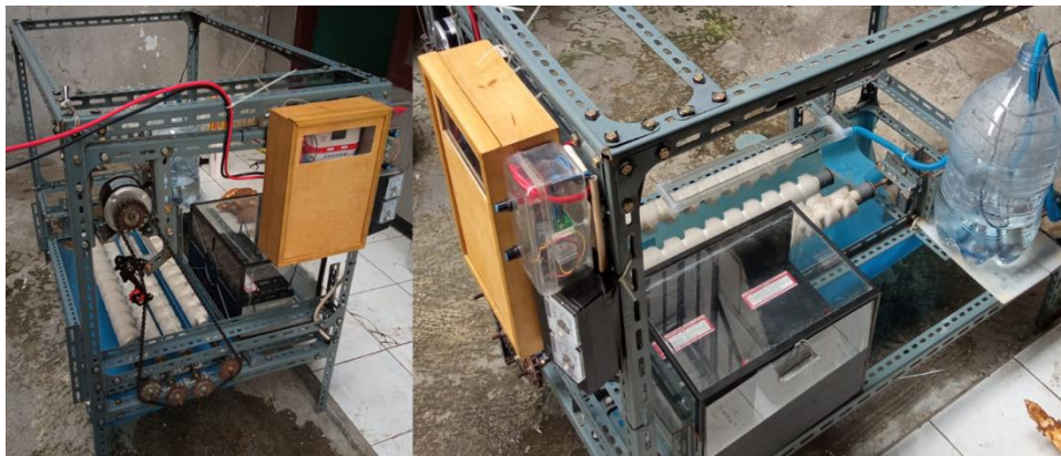
Gambar 3. Mesin pengupas kulit singkong tampak depan (a) dan tampak dekat sistem pengupasan dan sistem pencucian beserta komponen listriknya (b)
