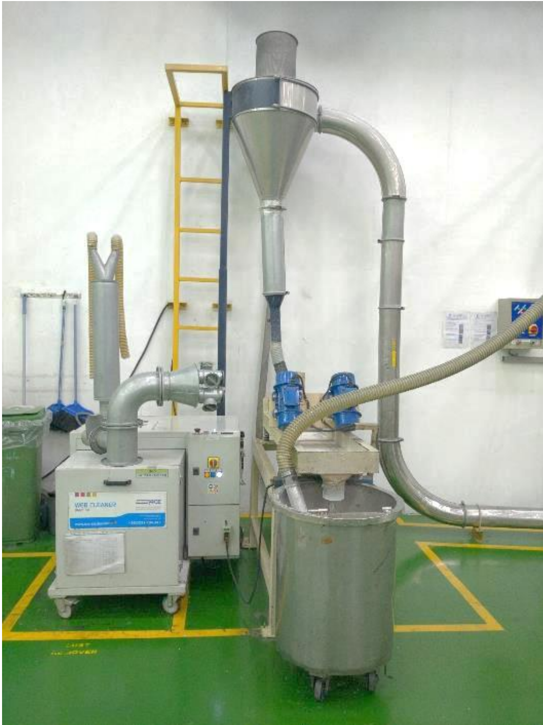
Gambar 7. Dust Collector untuk Breathable Backsheet Film
