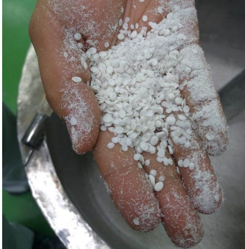
Gambar 6. Kontaminasi Debu pada Material Recycle
