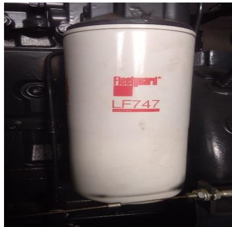
Gambar 7 Filter Oli Pada Genset
