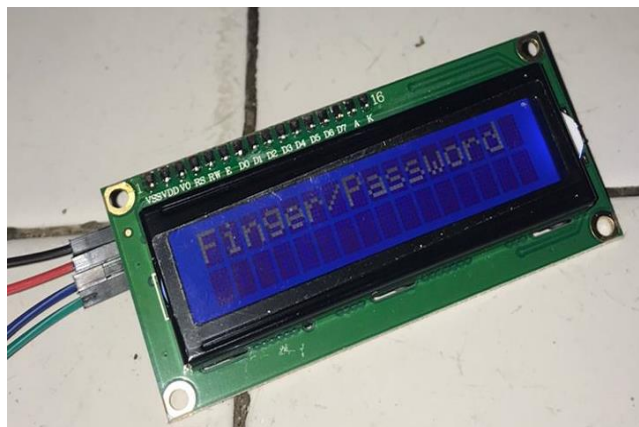
Gambar 5. tampilan LCD memasukkan finger/pin
