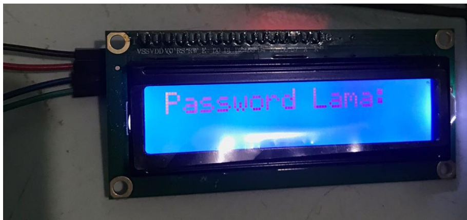
Gambar 12. Tampilan LCD mengganti Pin
