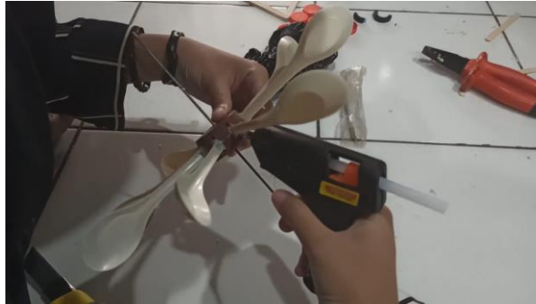
Gambar 4 Proses perakitan kincir air
