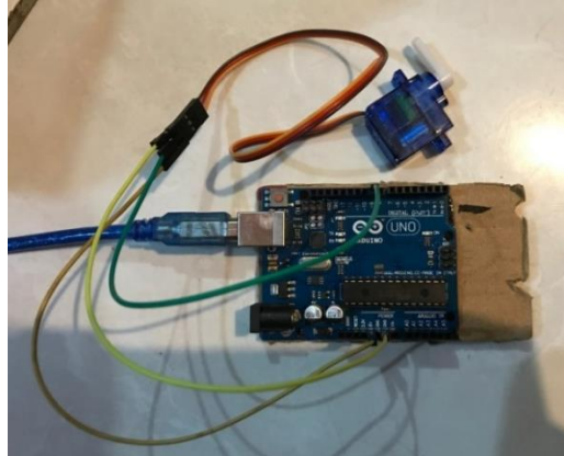
Gambar 6. Rangkaian arduino dengan motor servo
