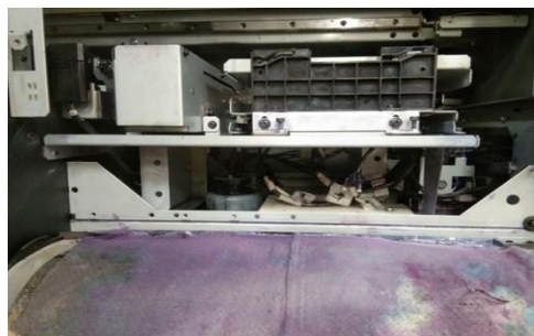
Gambar 4. Hasil cek area dalam mesin, ada terjadi tinta bocor.
