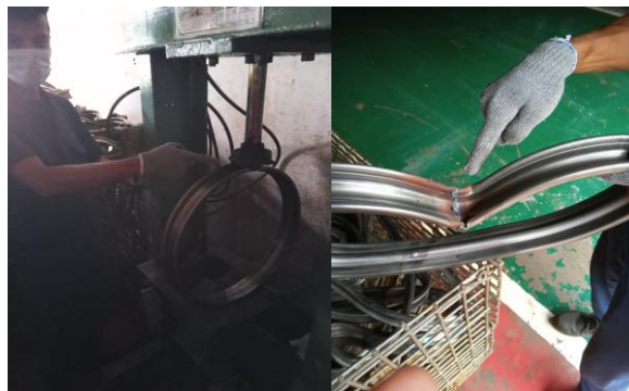
Gambar 18. Pengujian Kekuatan Hasil Las
