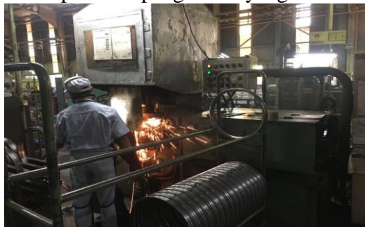
Gambar 2. Mesin Las Flashbutt
