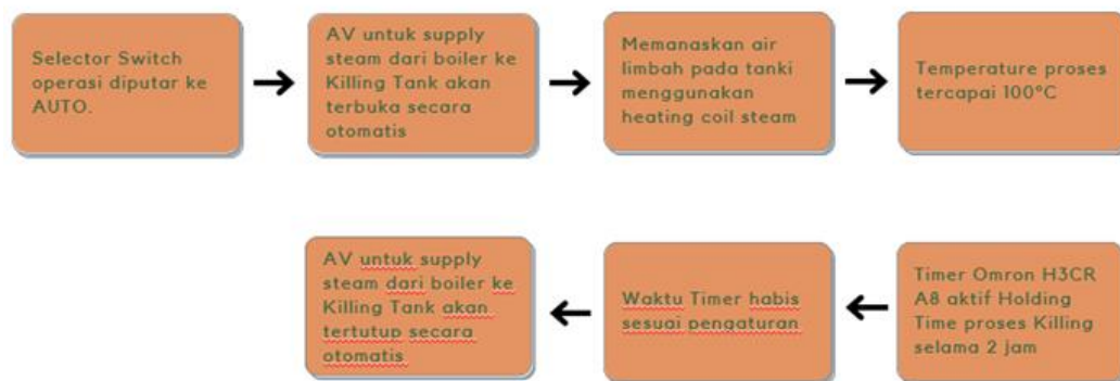
Gambar 10. Alur Mode Steam Setelah Ditambah Timer dan Relay
