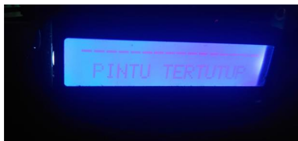
Gambar 7. Tampilan Kondisi Pintu Tertutup
