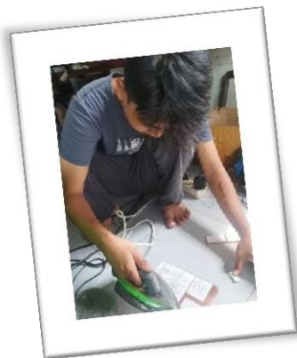
Gambar 4 Penyablonan PCB Toner Transfer Paper
