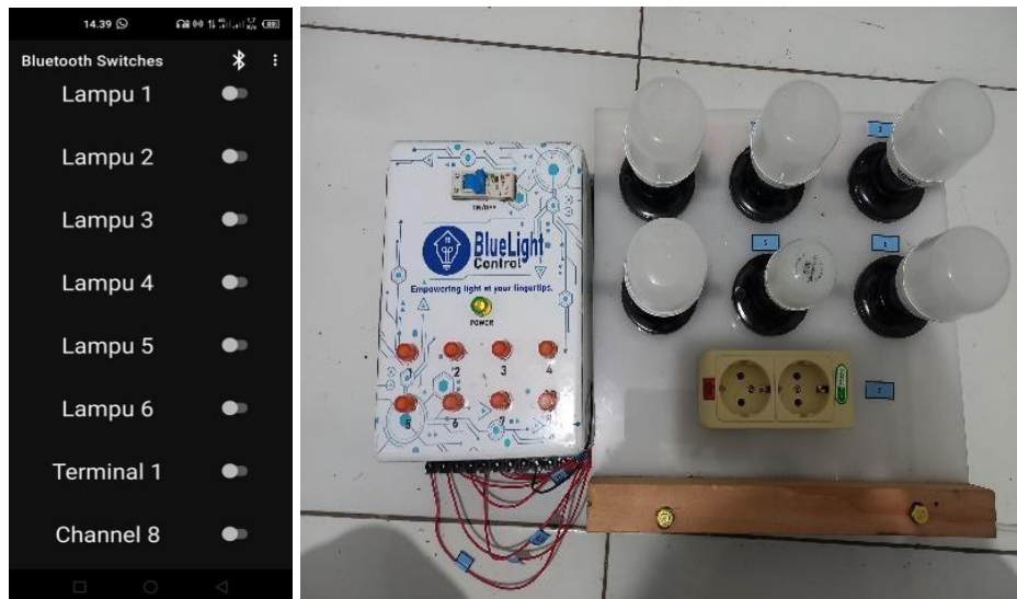
Gambar 4.9 Pengujian output relay saat mematikan lampu
