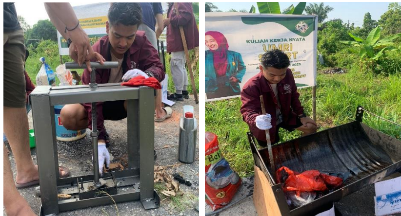
Gambar 4. Alat Pembuatan Paving Block
