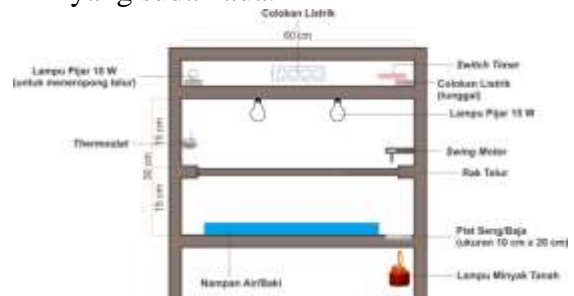
Gambar 8. Rangkaian alat mesin penetas telur
