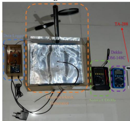
Gambar 9. Pengujian Perbandingan Data Logger dengan Alat Ukur Konvensional
