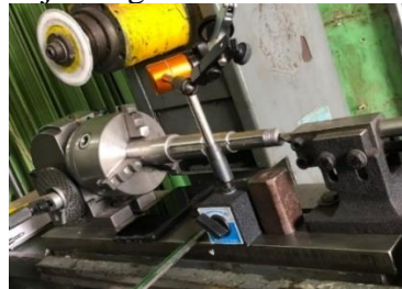
Gambar 12. Settingan keolengan dengan dial indikator
