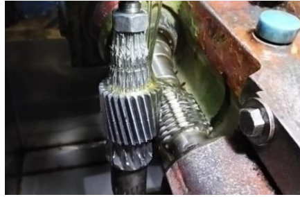
Gambar 14. Pembuatan profile roda gigi Proses Pemesinan pada Mesin Hardening dengan Delta Dynamic
