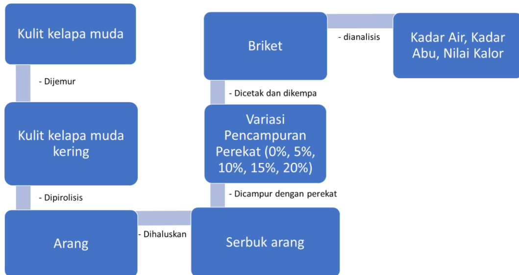
Gambar 1. Prosedur pembuatan briket arang
