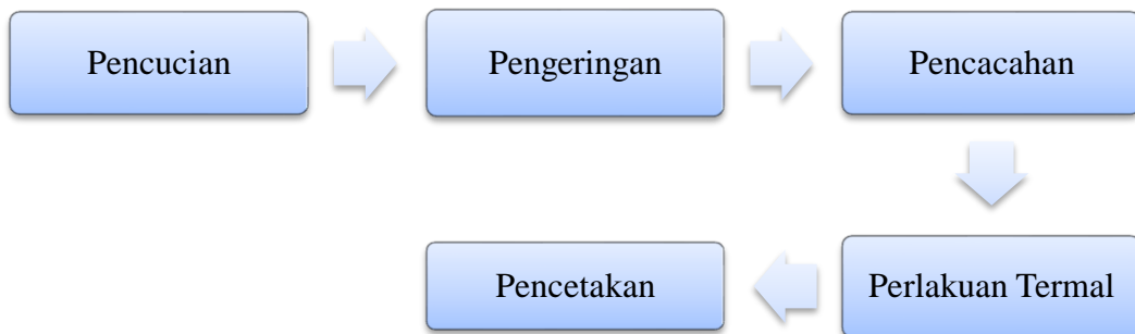
Gambar 3. Tahapan pembuatan Wood Plastic Composite (WPC)
