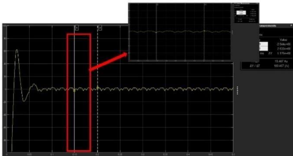
Gambar 8. Hasil Output CMV Dengan BBI Termodifikasi Pada MATLAB Ditambah Filter Aktif
