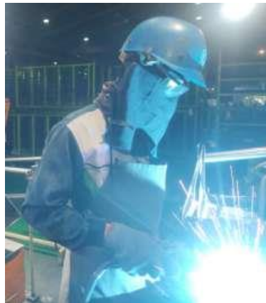
Gambar 1 Proses pengelasan MIG
