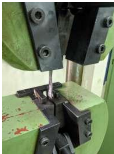
Gambar 5 Proses uji tarik
